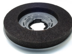
Disco Carborundum \varnothing 410\text{mm} Disco ideale per levigatura aggressiva su massetti cementizi, rimuove cordonature, sovra-spessori e vecchie colle.
