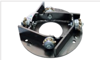
BUSH HAMMER utensile esclusivo utile per molte applicazioni.
