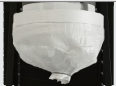
Sistema di scarico a sacco continuo.
